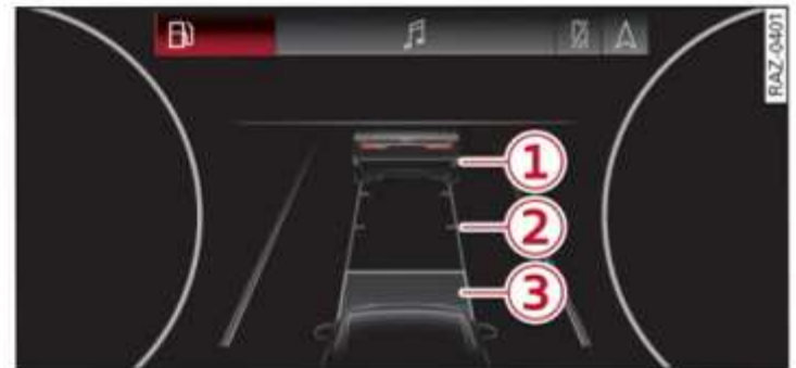
Fig. 115 Cuadro de instrumentos: Indicación de la distancia actual
