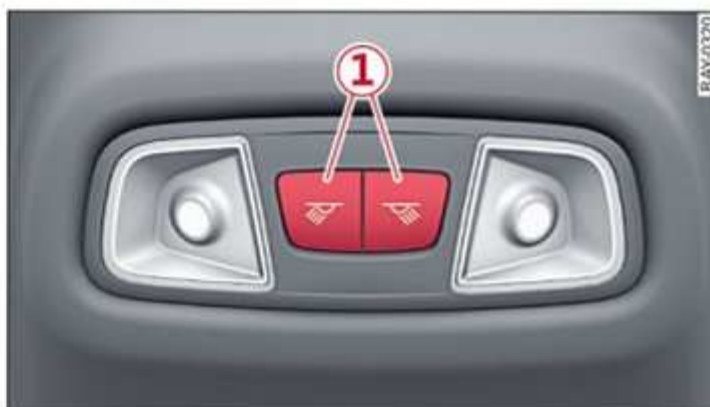
Fig. 39 Techo: Luces de lectura
