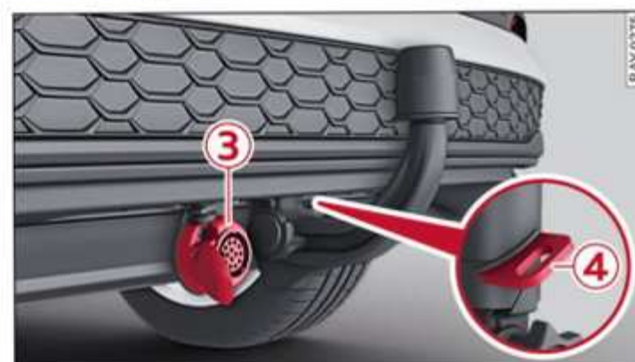
Fig. 87 Zona del parachoques trasero: Toma de corriente para el remolque (3), argolla para el cable de ruptura (4)
