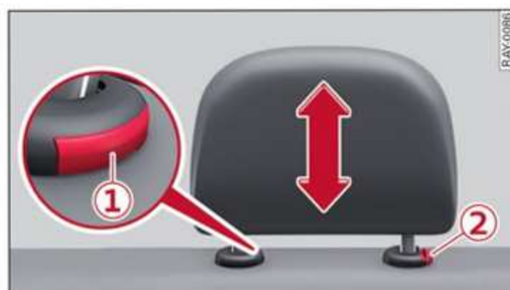
Fig. 52 Asiento trasero: Ajustar/desmontar el apoyacabezas
