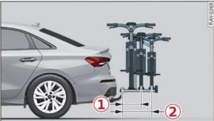
Fig. 90 Portaequipajes trasero: distancia horizontal máxima de la carga
