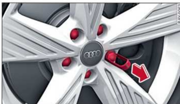
Fig. 174 Rueda: Tornillos de rueda con caperuzas de adorno
