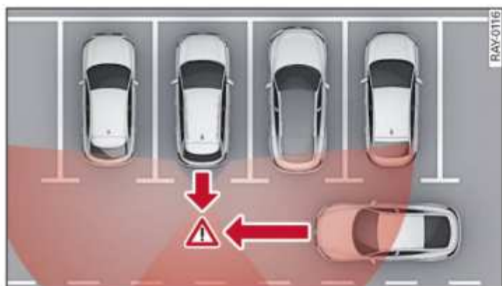
Fig. 127 Zona de detección de los sensores del sistema de asistencia trasero para el tráfico transversal
