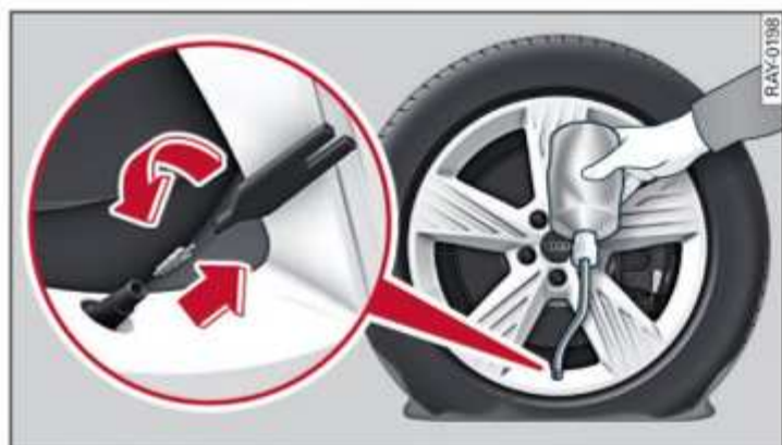
Fig. 171 Neumáticos: Llenar el neumático
