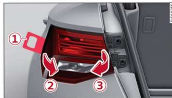
Fig. 195 Lateral: Desmontar el grupo óptico trasero
