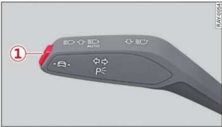
Fig. 117 Palanca de los intermitentes: Tecla para el aviso de salida de carril y el guiado por carril del asistente de conducción adaptativo*
