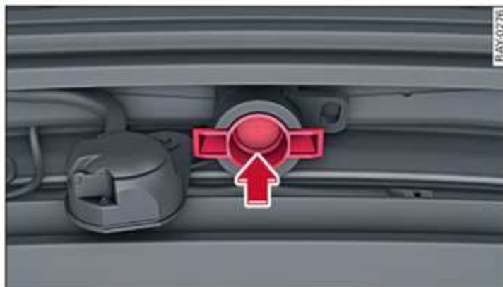
Fig. 89 Zona del parachoques trasero: Colocar el tapón
