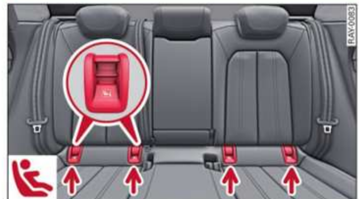
Fig. 62 Asiento trasero: Anclajes ISOFIX inferiores
