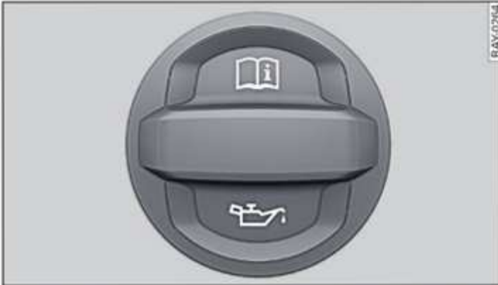
Fig. 159 Compartimento del motor: Tapón de la boca de llenado del aceite del motor (ejemplo)
