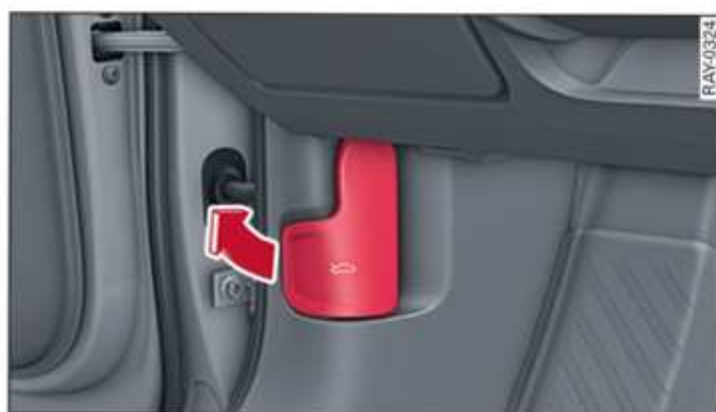
Fig. 154 Espacio reposapiés: Palanca de desbloqueo
