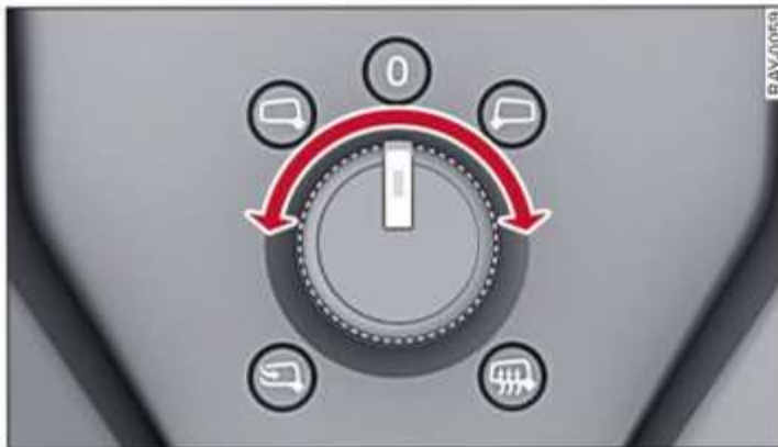
Fig. 40 Puerta del conductor: Mando giratorio para el retrovisor exterior
