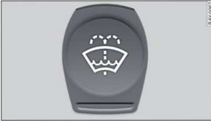
Fig. 163 Compartimento del motor: Tapa del depósito del líquido lavacrystales
