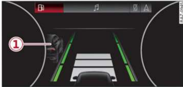
Fig. 114 Cuadro de instrumentos: impedimento para el adelantamiento
