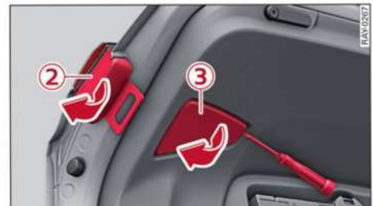
Fig. 199 Portón del maletero: Levantar/retirar las cubiertas
