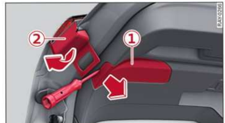
Fig. 198 Portón del maletero: Retirar las cubiertas
