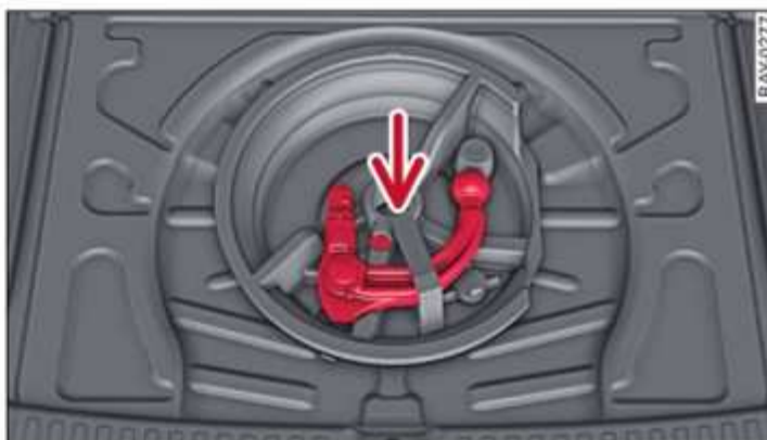
Fig. 81 Maletero: Alojamiento del dispositivo para remolque
