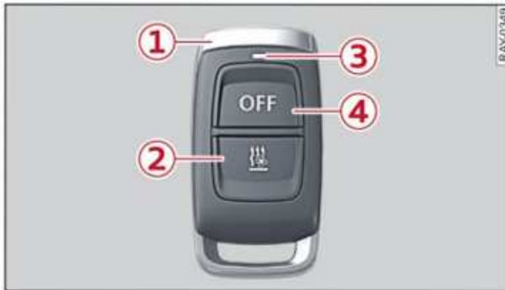
Fig. 76 Mando a distancia: Calefacción/ventilación independiente
