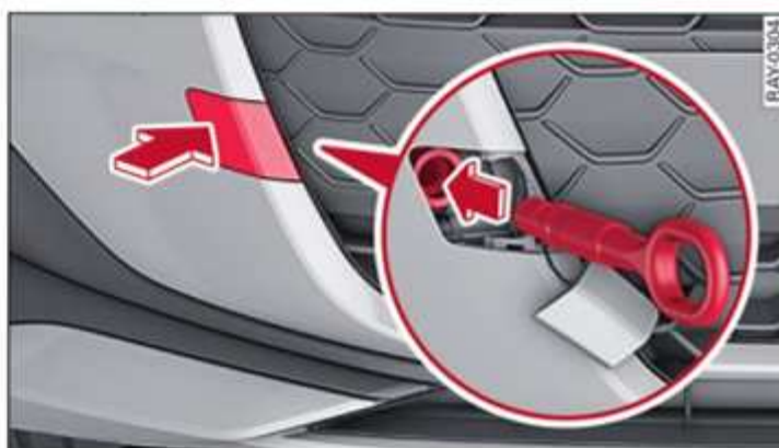
Fig. 183 Parachoques delantero: Enroscar la argolla de remolque
