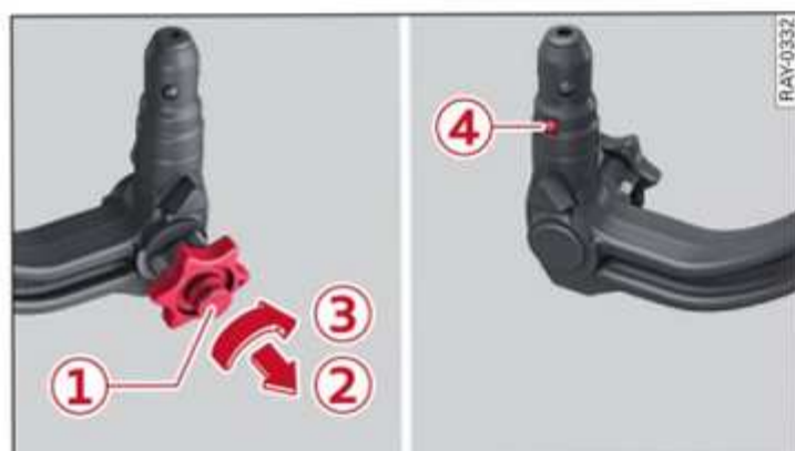
Fig. 84 Dispositivo desmontable para remolque: Pretensar la rótula
