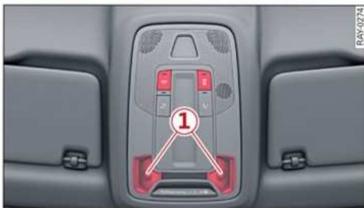
Fig. 38 Revestimiento del techo: Iluminación interior delantera
