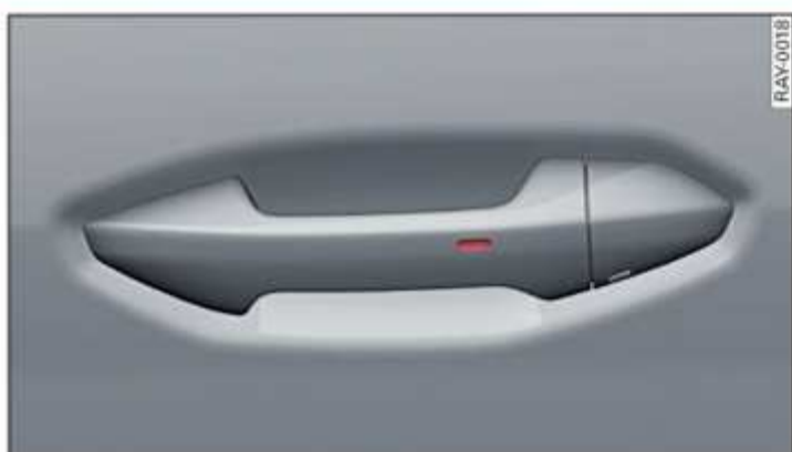
Válido para: vehículos con llave de confort Fig. 24 Manilla: Sensor* para bloquear
