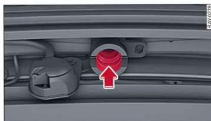
Fig. 85 Dispositivo desmontable para remolque: Colocar la rótula
