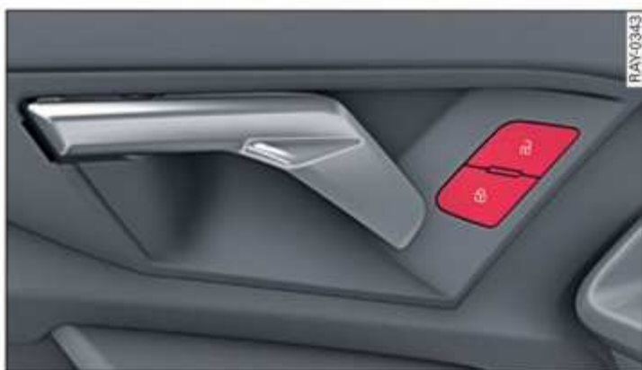
Fig. 20 Puerta del conductor: Mando del cierre centralizado
