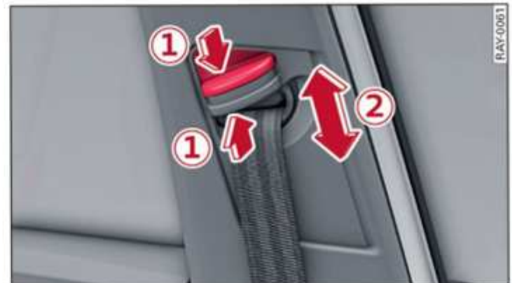
Fig. 57 Ajuste de la altura de los cinturones delanteros (dispositivo-guía)
