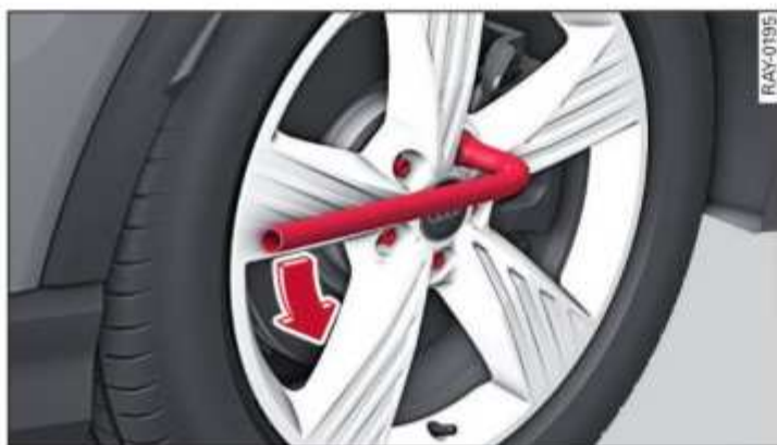
Fig. 176 Rueda: Aflojar los tornillos
