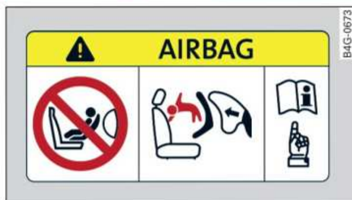
Fig. 61 Parasol del lado del acompañante: Adhesivo del airbag
