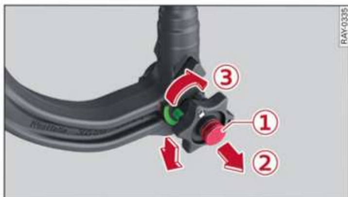
Fig. 88 Dispositivo desmontable para remolque: Desmontar la rótula
