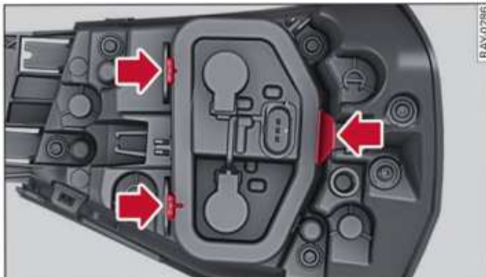
Fig. 196 Grupo óptico trasero: Lengüetas de fijación
