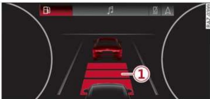
Fig. 109 Cuadro de instrumentos: Solicitud de intervención de frenado
