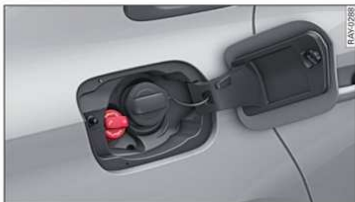
Fig. 152 Parte trasera derecha del vehículo: Desenroscar el tapón del AdBlue
