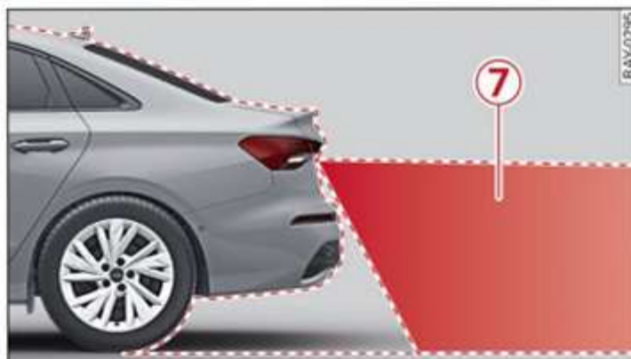
Fig. 93 Zona de detección de la cámara de marcha atrás
