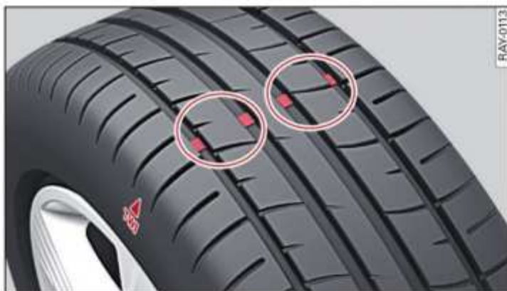
Fig. 164 Profundidad del dibujo: Indicador de desgaste
