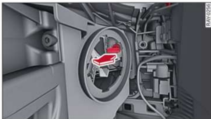
Fig. 192 Faro: Conector de plástico del intermitente
