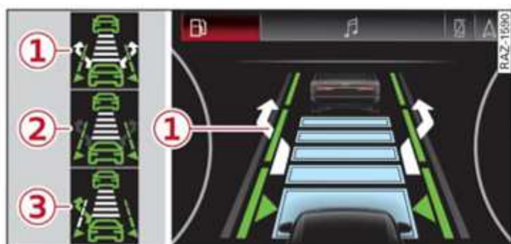
Fig. 108 Cuadro de instrumentos: indicación del cambio de carril asistido
