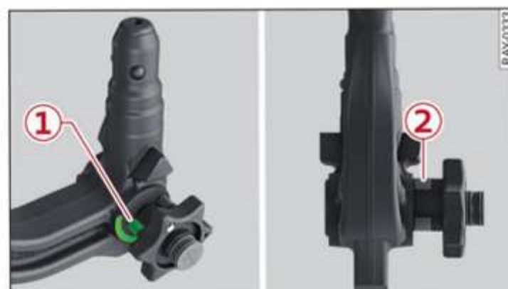
Fig. 86 Dispositivo desmontable para remolque: Comprobación de seguridad
