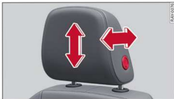
Fig. 51 Asiento delantero: Ajustar el apoyacabezas
