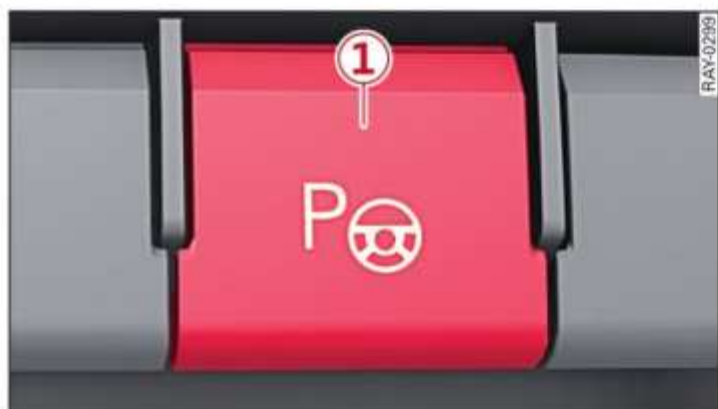
Fig. 130 Consola central: Tecla del sistema de aparcamiento asistido
