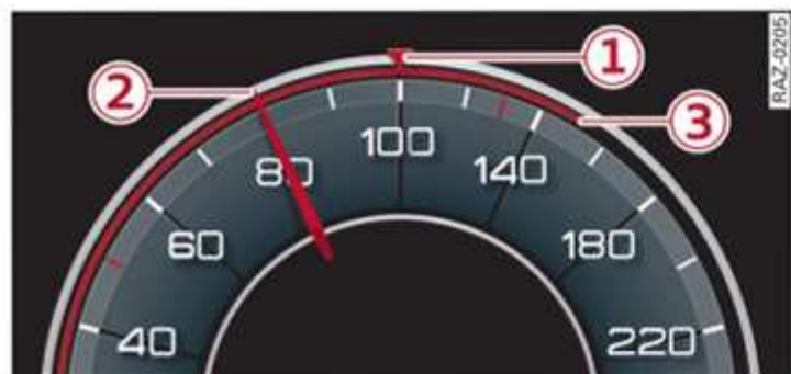
Fig. 103 Cuadro de instrumentos: Indicación en el velocímetro
