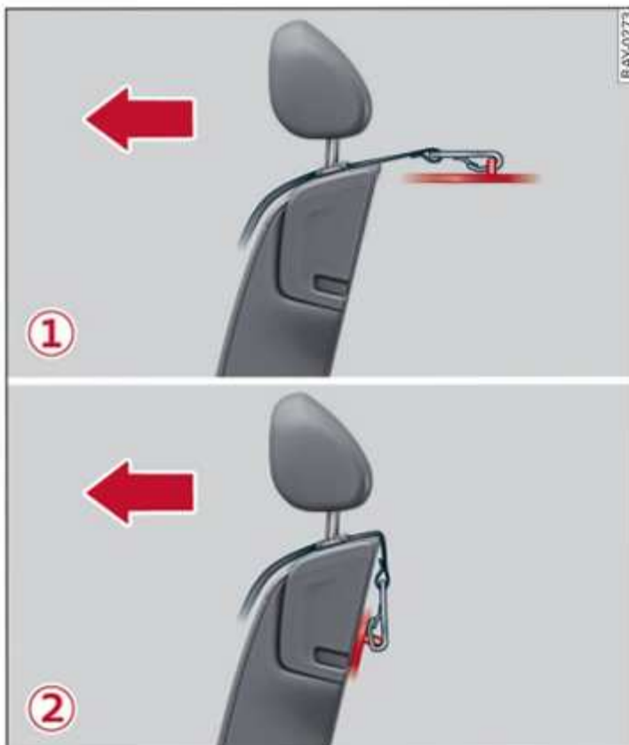
Fig. 64 Variante ① Bandeja trasera / Variante ② Respaldo trasero: Enganchar el cinturón de sujeción superior al anclaje Top Tether
