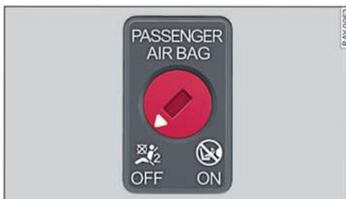
Fig. 59 Guantero: Interruptor de llave para desactivar el airbag del acompañante
