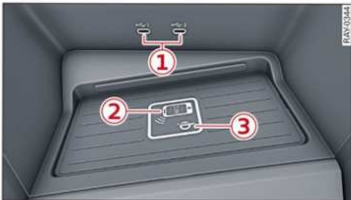
Fig. 132 Consola central delantera: Audi phone box con conexiones
