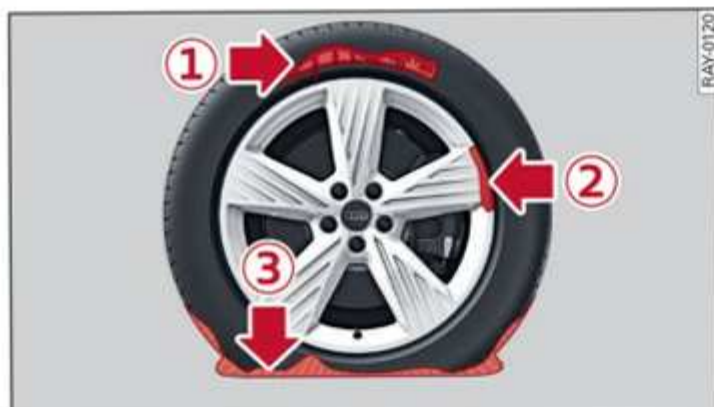
Fig. 170 Neumáticos: Daños irreparables en el neumático
