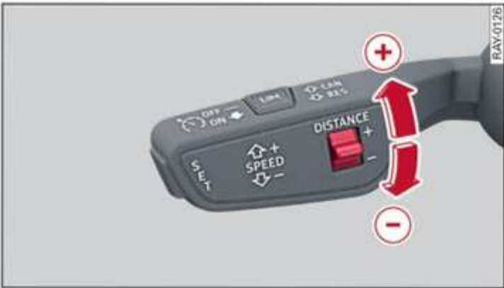
Fig. 111 Palanca de mando: Ajustar la distancia
