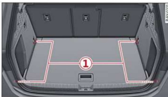
Fig. 70 Maletero: Disposición de las argollas de amarre
