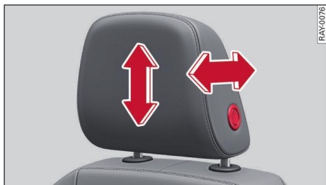
Fig. 51 Asiento delantero: Ajustar el apoyacabezas
