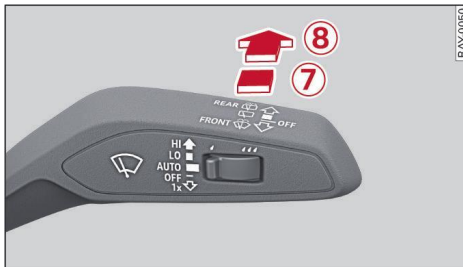
Fig. 43 Palanca de accionamiento: Limpialuneta*
