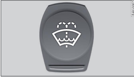
Fig. 163 Compartimento del motor: Tapa del depósito del líquido lavacristales
