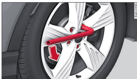
Fig. 176 Rueda: Aflojar los tornillos
