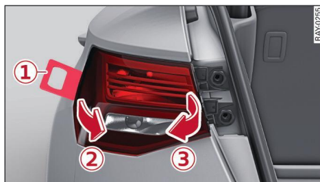
Fig. 195 Lateral: Desmontar el grupo óptico trasero
