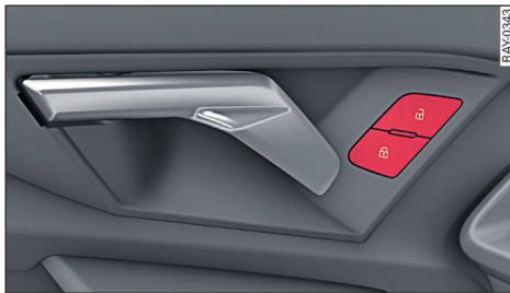
Fig. 20 Puerta del conductor: Mando del cierre centralizado
