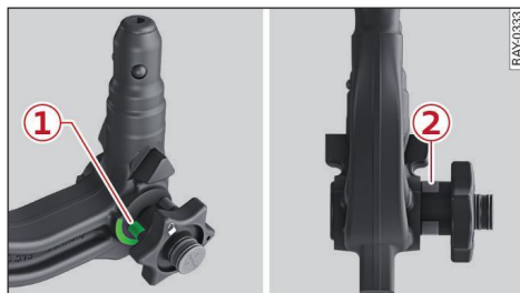
Fig. 86 Dispositivo desmontable para remolque: Comprobación de seguridad
