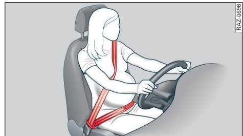
Fig. 54 Colocación de la banda del cinturón en el caso de mujeres embarazadas
