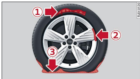
Fig. 170 Neumáticos: Daños irreparables en el neumático
