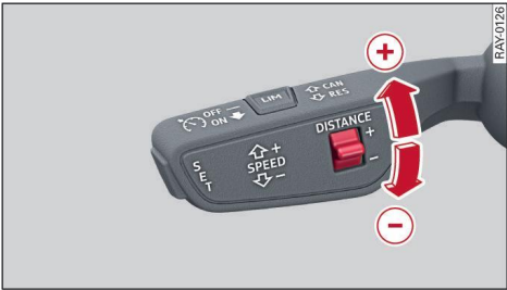
Fig. 111 Palanca de mando: Ajustar la distancia
