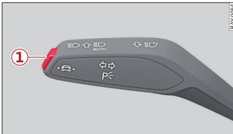
Fig. 107 Palanca de los intermitentes: Tecla para guiado por carril
