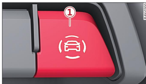
Fig. 96 Consola central: Tecla para sistemas de asistencia al conductor
