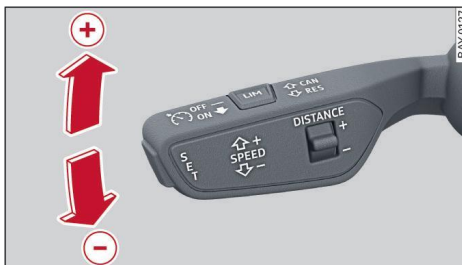
Fig. 106 Palanca de mando: Modificar la velocidad
