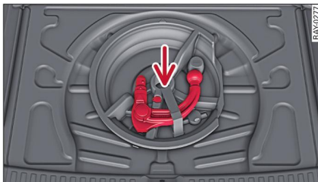
Fig. 81 Maletero: Alojamiento del dispositivo para remolque
