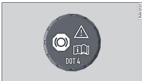
Fig. 161 Compartimento del motor: Tapa del depósito del líquido de frenos
