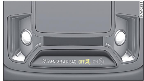
Fig. 60 Techo: Testigo de control con indicación de estado del airbag del acompañante
