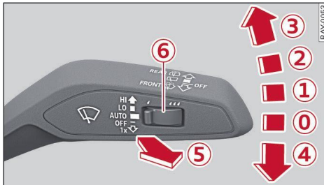
Fig. 42 Palanca de accionamiento: Limpiacristales
