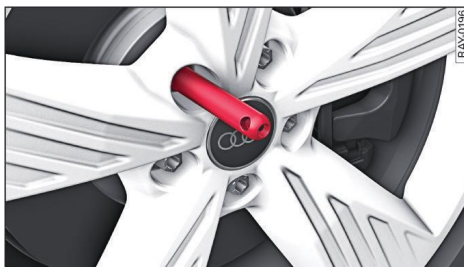
Fig. 180 Rueda: Pasador de montaje en el orificio superior
