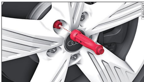
Fig. 179 Rueda: Útil de hexágono interior para girar los tornillos
