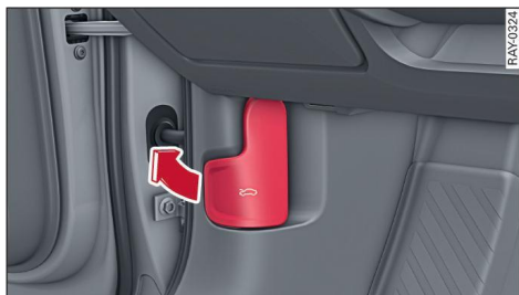
Fig. 154 Espacio reposapiés: Palanca de desbloqueo
