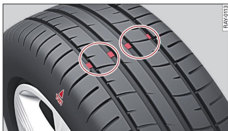
Fig. 164 Profundidad del dibujo: Indicador de desgaste
