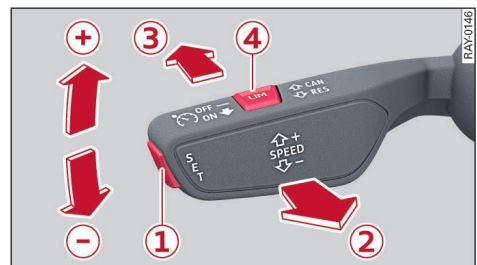
Fig. 100 Palanca de accionamiento: conectar el sistema
