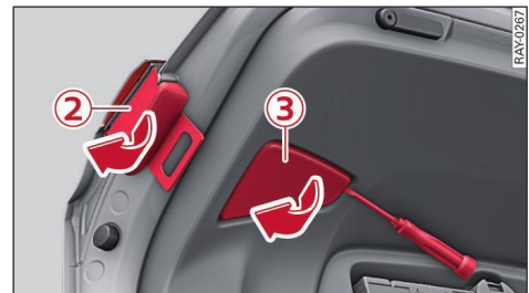
Fig. 199 Portón del maletero: Levantar/retirar las cubiertas
