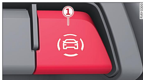
Fig. 112 Consola central: Tecla para sistemas de asistencia al conductor
