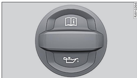
Fig. 178 Compartimento del motor: Tapón de la boca de llenado del aceite del motor (ejemplo)
