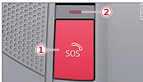
Fig. 152 Parte delantera del techo: Cubierta para la tecla de llamada de emergencia
