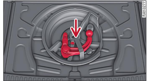
Fig. 97 Maletero: Alojamiento del dispositivo para remolque
