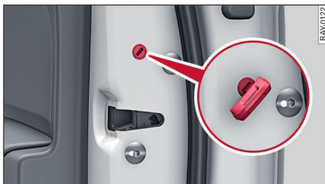
Fig. 22 Puerta: Bloqueo de emergencia
