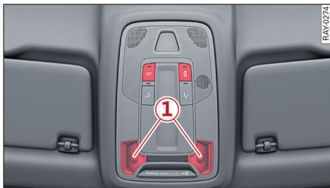
Fig. 38 Revestimiento del techo: Iluminación interior delantera
