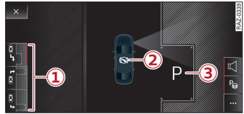
Fig. 147 Pantalla central: Búsqueda de hueco de aparcamiento activada
