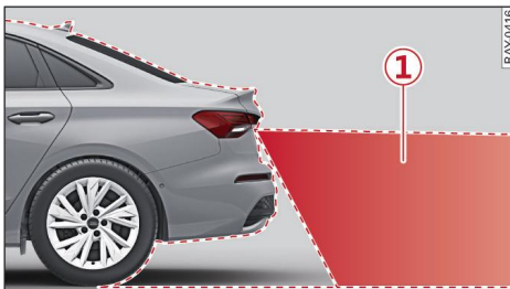
Fig. 109 Zona de detección de la cámara de marcha atrás
