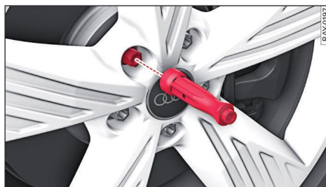
Fig. 201 Rueda: Útil de hexágono interior para girar los tornillos
