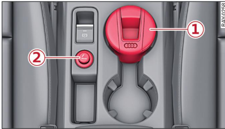
Fig. 66 Consola central delantera: Cenicero y encendedor
