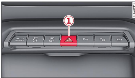
Fig. 37 Consola central: Intermitentes de emergencia
