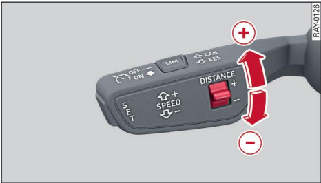
Fig. 127 Palanca de mando: Ajustar la distancia
