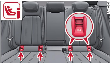
Fig. 62 Asiento trasero: Anclajes ISOFIX inferiores
