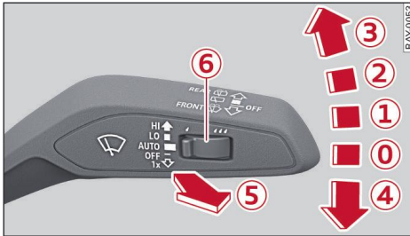
Fig. 42 Palanca de accionamiento: Limpiacristales
