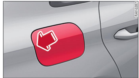
Fig. 168 Lado trasero derecho: Abrir la tapa del depósito
