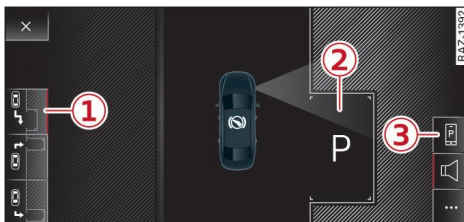
Fig. 148 Pantalla central: Aparcamiento por control remoto - Preparar el vehículo
