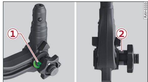
Fig. 102 Dispositivo desmontable para remolque: Comprobación de seguridad
