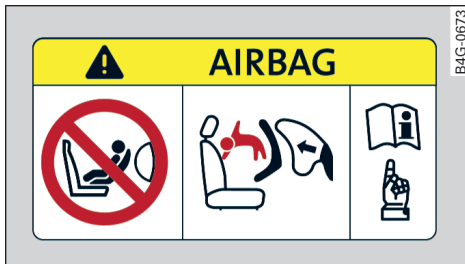
Fig. 61 Paraisol del lado del acompañante: Adhesivo del airbag
