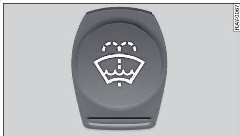
Fig. 184 Compartimento del motor: Tapa del depósito del líquido lavacristales
