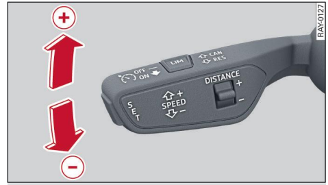
Fig. 122 Palanca de mando: Modificar la velocidad
