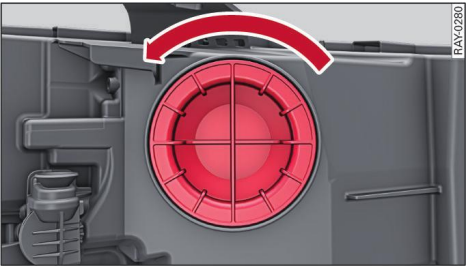
Fig. 213 Faro: Cubierta del intermitente
