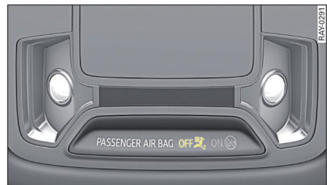
Fig. 60 Techo: Testigo de control con indicación de estado el airbag del acompañante
