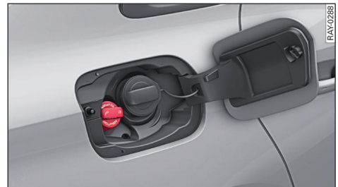
Fig. 170 Parte trasera derecha del vehículo: Desenroscar el tapón del AdBlue
