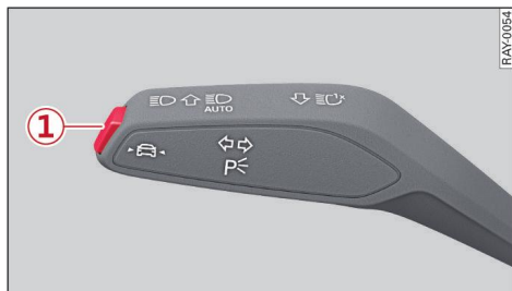
Fig. 133 Palanca de los intermitentes: Tecla para el aviso de salida de carril y el guiado por carril del asistente de conducción adaptativo*
