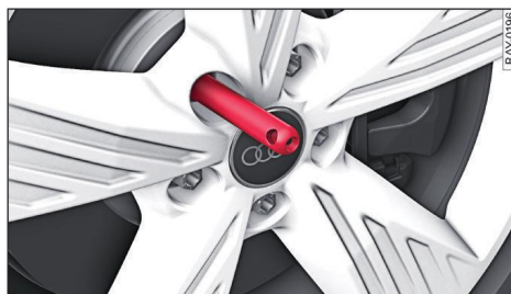
Fig. 202 Rueda: Pasador de montaje en el orificio superior
