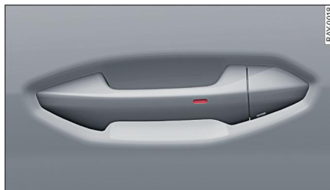
Fig. 24 Manilla: Sensor* para bloquear
