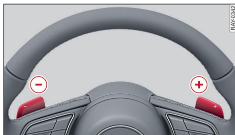
Fig. 81 Volante: Levas de cambios*
