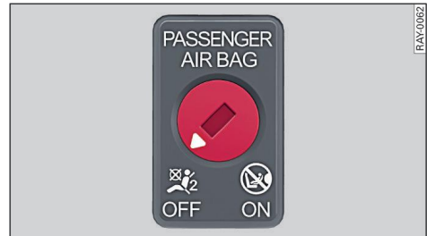
Fig. 59 Guantero: Interruptor de llave para desactivar el airbag del acompañante
