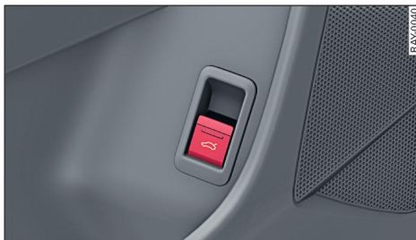
Fig. 27 Puerta del conductor: Abrir el portón del maletero
