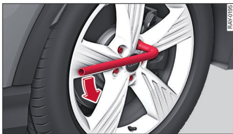
Fig. 198 Rueda: Aflojar los tornillos
