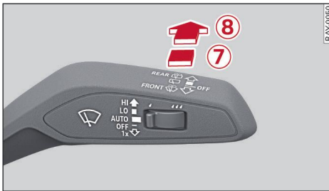
Fig. 43 Palanca de accionamiento: Limpialuneta*
