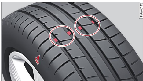
Fig. 185 Profundidad del dibujo: Indicador de desgaste
