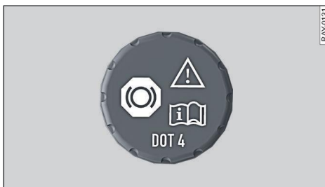
Fig. 181 Compartimento del motor: Tapa del depósito del líquido de frenos
