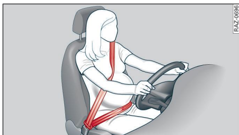
Fig. 54 Colocación de la banda del cinturón en el caso de mujeres embarazadas
