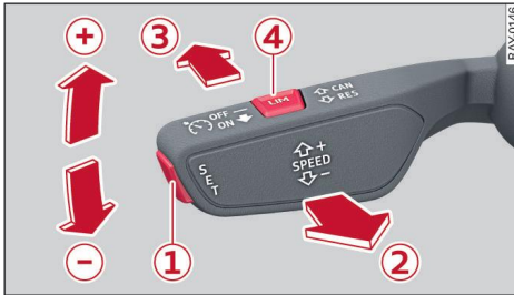
Fig. 116 Palanca de accionamiento: conectar el sistema
