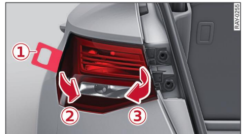
Fig. 217 Lateral: Desmontar el grupo óptico trasero
