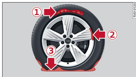
Fig. 192 Neumáticos: Daños irreparables en el neumático
