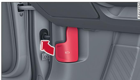
Fig. 172 Espacio reposapiés: Palanca de desbloqueo
