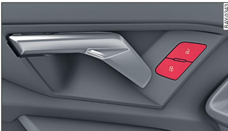
Fig. 20 Puerta del conductor: Mando del cierre centralizado
