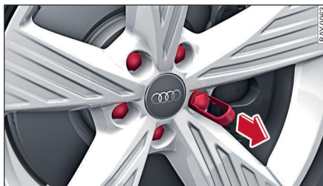
Fig. 196 Rueda: Tornillos de rueda con caperuzas de adorno
