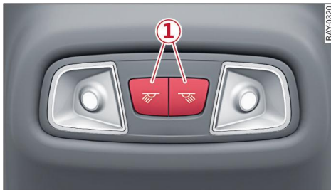
Fig. 39 Techo: Luces de lectura
