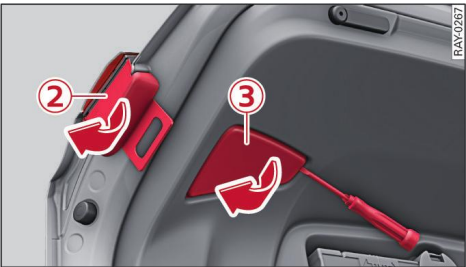
Fig. 221 Portón del maletero: Levantar/retirar las cubiertas
