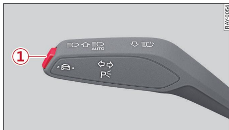
Fig. 123 Palanca de los intermitentes: Tecla para guiado por carril
