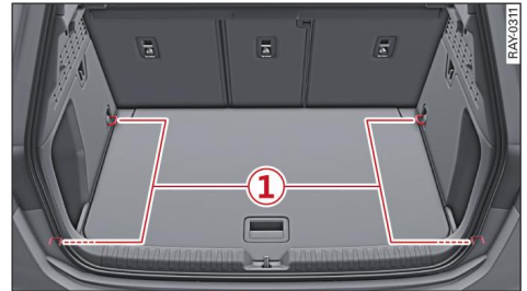
Fig. 71 Maletero: Disposición de las argollas de amarre
